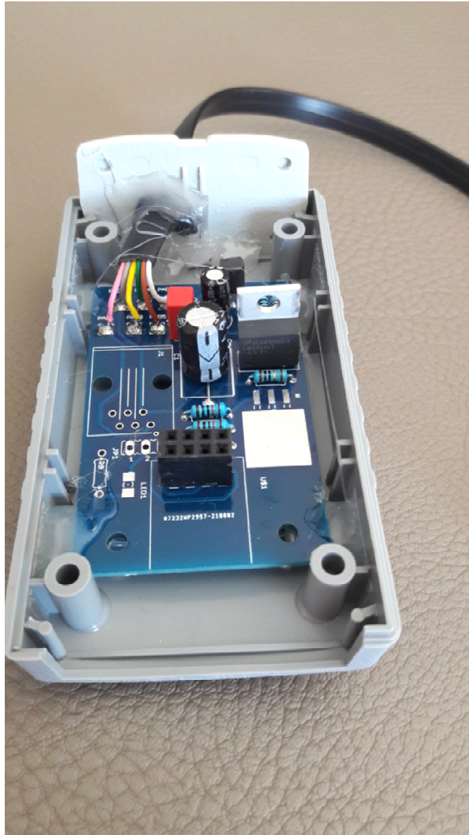
De afgewerkte interface zonder ESP01s met vaste aansluitingen en ingebouwd in een PVC-kastje (Gotron) Let op de correcte plaatsing van de LM3940!
