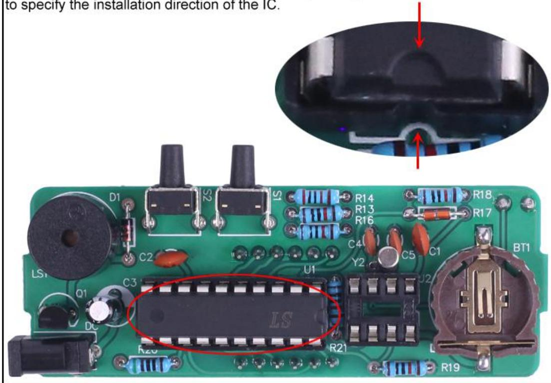
Step 20: Install 1pcs DIP-8 IC DS1302 Clock Chip at U2 in the same method.
